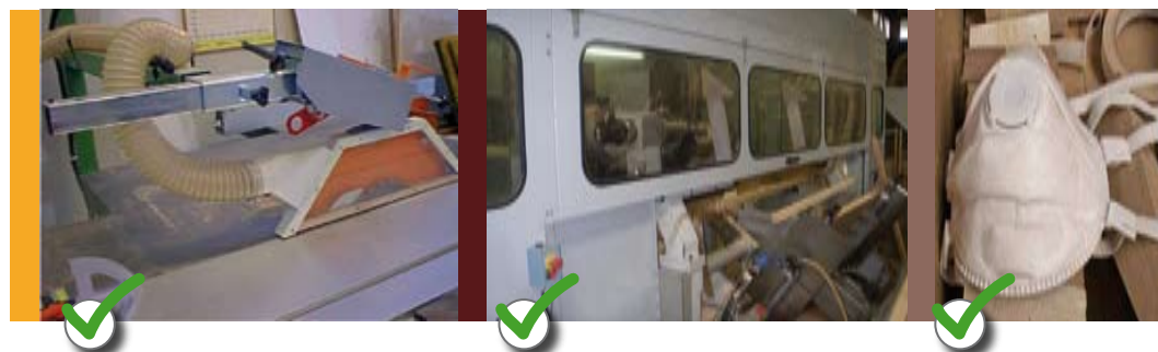
Mesures de protections collective (captage à la source) et individuelle (masque de type P2).
