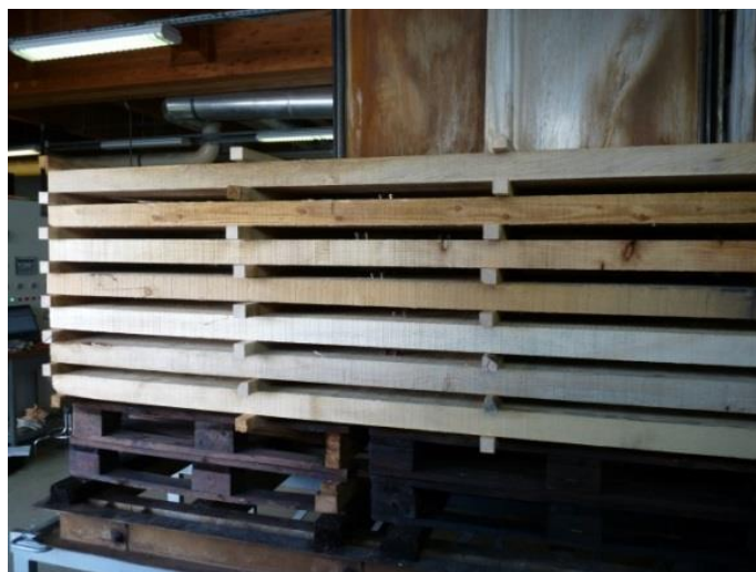
Photo 1 : Chargement du séchoir air chaud climatisé du laboratoire de FCBA
